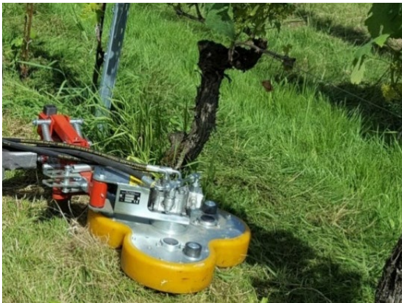
Figure 2: Untervine mulcher (Bernhardsgrütter Landtechnik AG)
