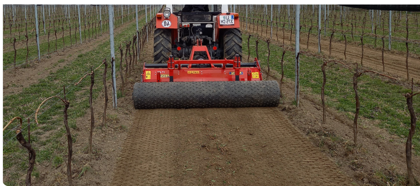
Ganzflächiges Saatbett mit 210 cm Arbeitsbreite
