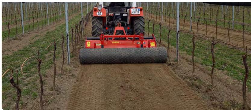
Ganzflächiges Saatbett mit 210 cm Arbeitsbreite
