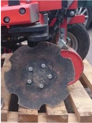
Bild 1: Pflugscheibe (Luttenberger und Steiner 2022)
