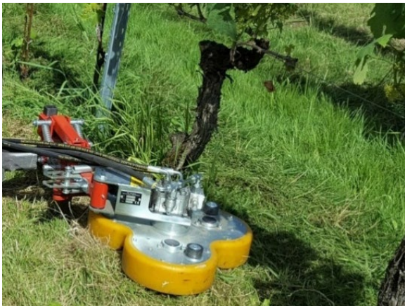
Bild 2: Unterstockmulcher (Bernhardsgrütter Landtechnik AG)
