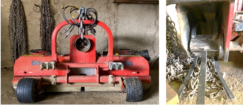
Bild 7: Bürstgerät auf Mulcher aufgebaut (FS Silberberg)
