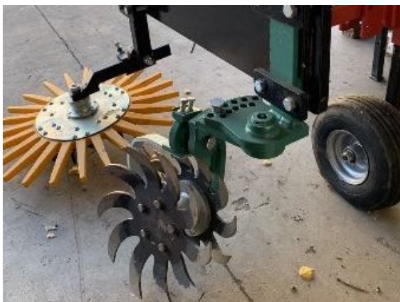
Bild 3: Rollhacke und Fingerhacke (Luttenberger und Steiner 2022)
